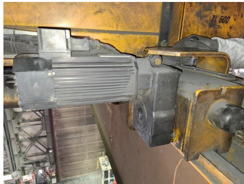
Люфт посадочных соединений редукторов передвижения грузовой тележки.
